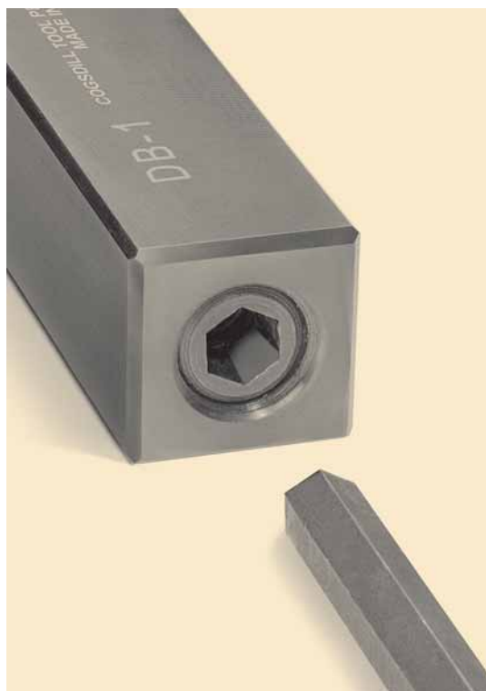
金刚石抛光工具可调节，以获得最佳抛光压力。对于 DB-1 和 DB-2 型号，调节螺钉位于工具的末端。对于 DB-3 和 DB-4 型号，调节螺钉位于工具的侧面。
