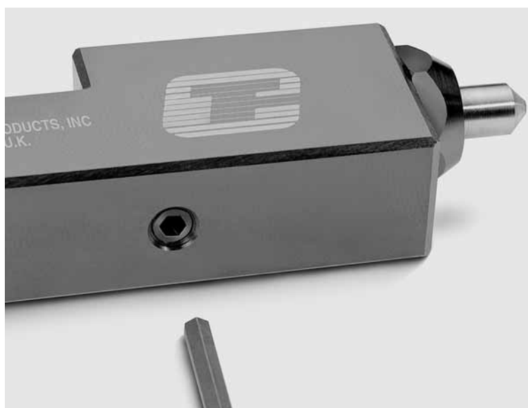
金刚石抛光工具可调节，以获得最佳抛光压力。对于 DB-1 和 DB-2 型号，调节螺钉位于工具的末端。对于 DB-3 和 DB-4 型号，调节螺钉位于工具的侧面。
